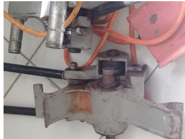
Figura 4. Desalineación del rodillo de la máquina ranuradora averiada. (Elaboración propia).
