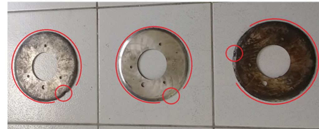
Figura 1. Daños sufridos en los discos de corte. (Elaboración propia).
