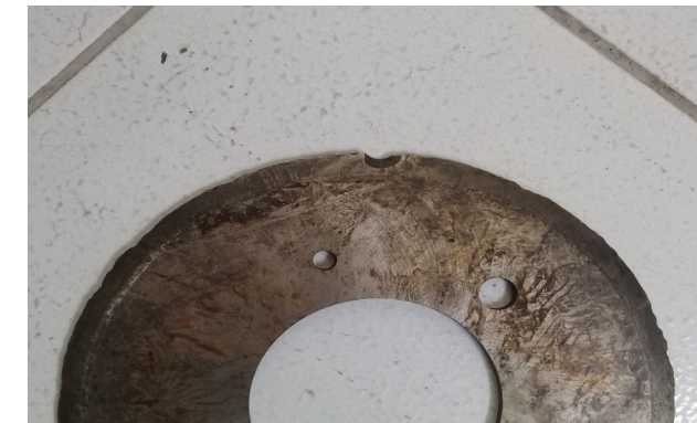
Figura 2. Expulsión masiva de metal en el perímetro del disco de corte. (Elaboración propia).
