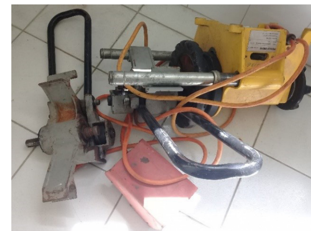
Figura 3. Máquina ranuradora averiada. (Elaboración propia).
