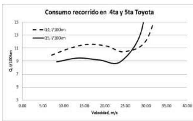
Figura 4a. Indicador de consumo recorrido en marcha directa y marcha superior, vehículo original. Fuente: elaboración propia.
