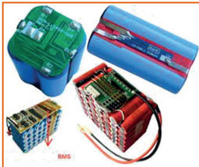
Figura 2. BMS de batería de iones de litio.
